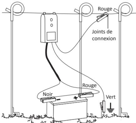
L'électrificateur peut être placé sur la clôture à l'aide des crochets situés sur le dessus du boîtier.
