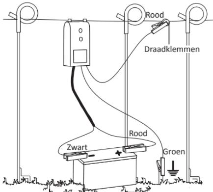
Met de ophanggaten aan de bovenkant kan het apparaat aan de afrasteringsdraad gehangen worden.
