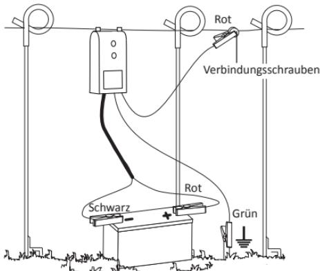
Mit den Befestigungshaken auf der Oberseite, kann das Gerät auf einem Zaun Draht gehängt werden.
